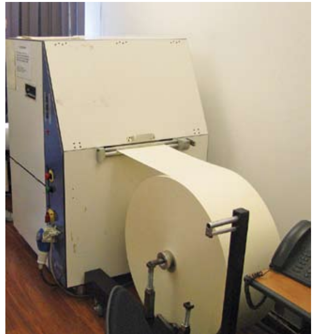
L'imprimante braille de l'Association pour le Bien des Aveugles qui nous permet d'imprimer un livre braille en 5 minutes
